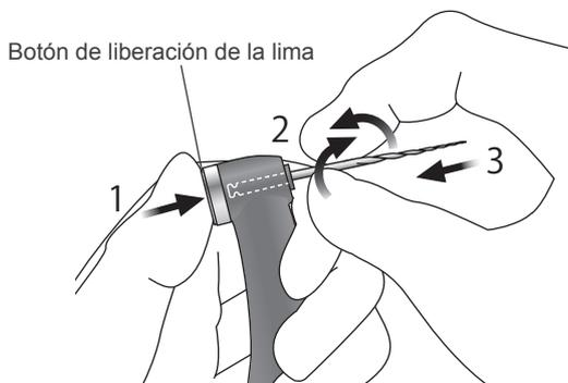
Mantenga presionado el botón de liberación de la lima. Introduzca la lima y gírela en ambos sentidos hasta que quede alineada con el mecanismo de sujeción. Introduzca a fondo la lima hasta que quede totalmente fijada por el sistema de sujeción. Suelte el botón de liberación de la lima.
