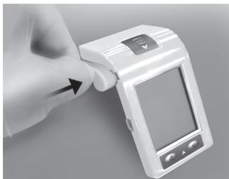
1. Inserire il cavetto della sonda a fondo nel connettore presente sul lato sinistro di S-Apex.
