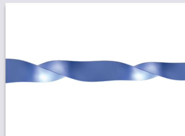
O design exclusivo e patenteado de arestas de corte alternadas reduz o efeito de aparafusamento, promovendo melhor controlo da progressão do instrumento no canal.
